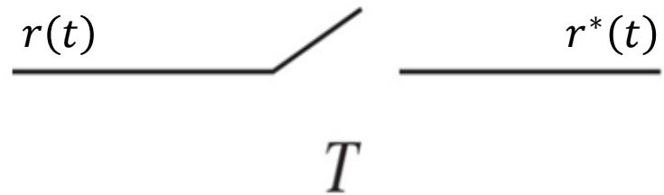
$$r^*(t) = r(0)\delta(t) + r(T)\delta(t - T) + r(2T)\delta(t - 2T) + \dots$$
